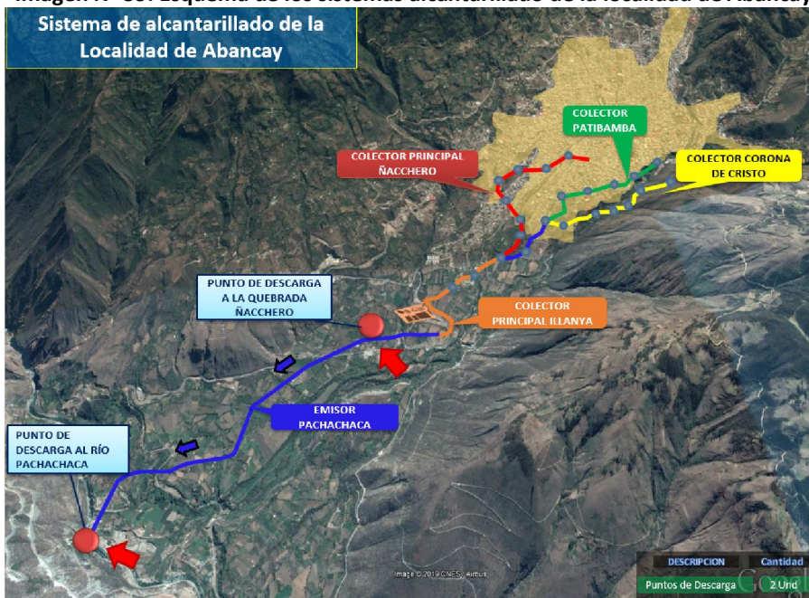
Imagen N° 39: Esquema de los sistemas alcantarillado de la localidad de Abancay
